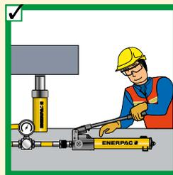
✓ Ne pas utiliser de rallonge pour le levier. La manoeuvre des pompes à main se révèle facile, lorsqu'elles sont utilisées correctement.
