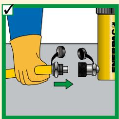
✓ Nettoyer les deux parties du raccord avant de les assembler. Utiliser les bouchons de protection lorsque les parties de raccord ne sont pas assemblées.
