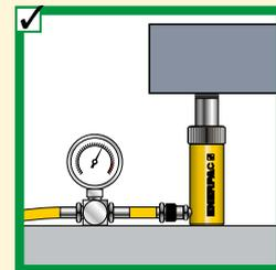
✓ Ne pas dépasser le tarage des soupapes de sécurité effectué en usine. Toujours utiliser un manomètre pour vérifier la pression du système.
