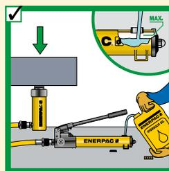
✓ Ne remplir la pompe que jusqu'au niveau recommandé. Ne remplir que lorsque le piston du vérin est complètement rentré.
