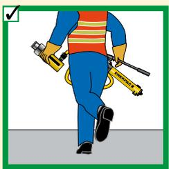
✓ Ne pas soulever l'équipement hydraulique à l'aide des flexibles.
