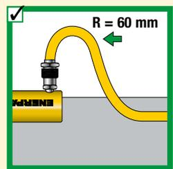
✓ Ne pas plier les flexibles. Le rayon de courbure ne doit pas être inférieur à 60 mm. Ne pas rouler ou laisser tomber des objets lourds sur les flexibles.
